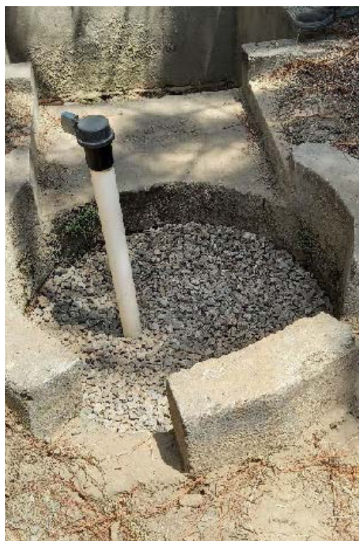
Figura 15. Ejemplo de un piezómetro instalado en un pozo seco para colocar el datalogger y protegerlo.
